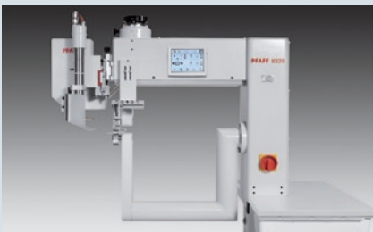
PFAFF 8320-020 - Programmierbare Heißluft-Schweißmaschine
