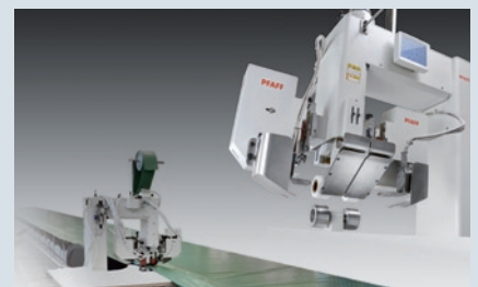
PFAFF 8390 (Zweikopf) - Heizkeilanlage mit zwei Schweißköpfen für das Verschweißen von großflächigen Materialien
